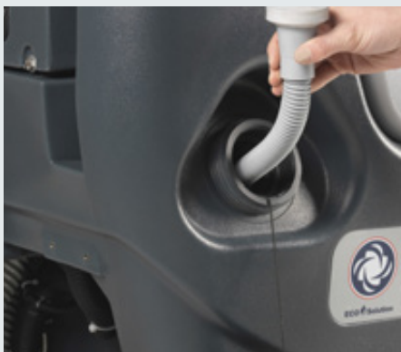
Manguera de llenado a bordo para un simultáneo llenado y vaciado de depósito.
