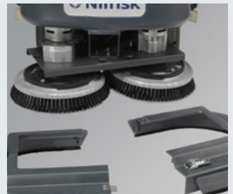
Gracias a las nuevas cubiertas móviles protectoras, se puede acceder al cepillo de forma instantánea.
