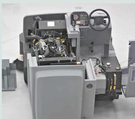
El sistema de Nilfisk NoTools™ hace que el mantenimiento sea extremadamente fácil. Sus 5 accesos al motor y a sus componentes hidráulicos permiten ahorrar tiempo y reducir los costes de mantenimiento.
