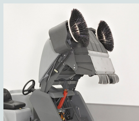
La SW8000 tiene una gran capacidad en su tolva de 152 cm desde el nivel del suelo para un llenado práctico.
