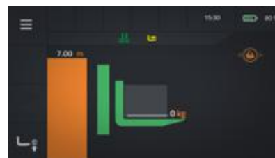
Horquillas subidas a una altura de elevación de 7,00 m
