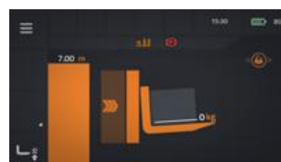
Horquillas inclinadas y desplazadas lateralmente
