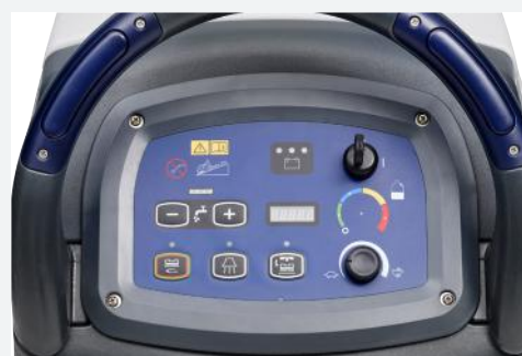
La regulación del flujo de disolución se puede cambiar desde la posición de conducción de acuerdo con el tipo de suelo y el nivel de suciedad
